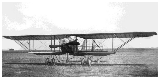
Izquierda: Caudron G-3EP2 (motor Anzani 100 hp). Derecha: Caudron G-3EP N.º II (motor Le Rhône 80 hp). El ejército dispuso de lotes de aeronaves militares francesas e italianas, pero además fabricó o reconstruyó en sus talleres una significativa cantidad de estos aviones (alrededor de 88 unidades) por cuenta de terceros o con fondos propios para destinarlos a unidades operativas e instituciones civiles.
