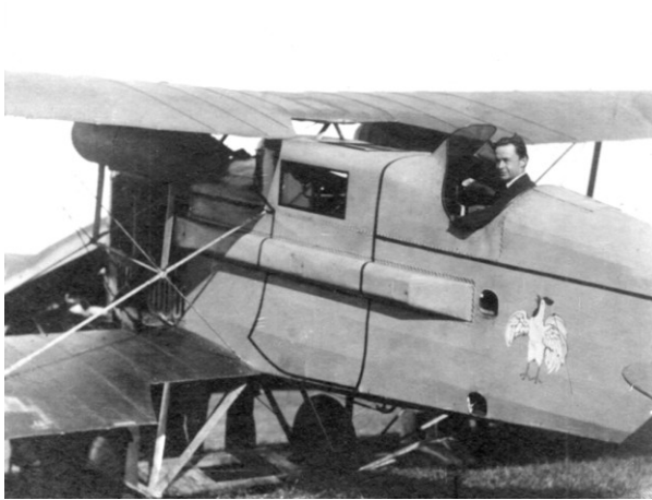
Izquierda: Breguet XIV Limousine San Luis con Enrique Rottjer. Nótese el sistema de calefacción de cabina con un ducto de ventilación que sale del motor, el tanque complementario subalar para vuelos de larga duración y en su fuselaje la misma caricatura del gallo francés utilizado. Derecha: Bleriot-SPAD XIII aerofotógrafo con Vicente Almandos Almonacid en San Luis 14
