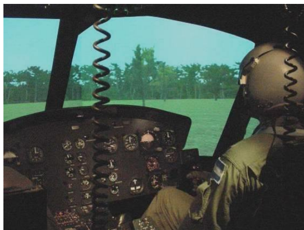
Simulador Frasca de helicóptero Bell UH-1H usado por la Escuela de Aviación de Ejército donde se puede apreciar la tecnología de escenarios FTD
