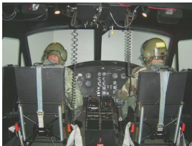
Simulador Frasca de helicóptero Bell UH-1H usado por la Escuela de Aviación de Ejército donde se puede apreciar la tecnología de escenarios FTD
