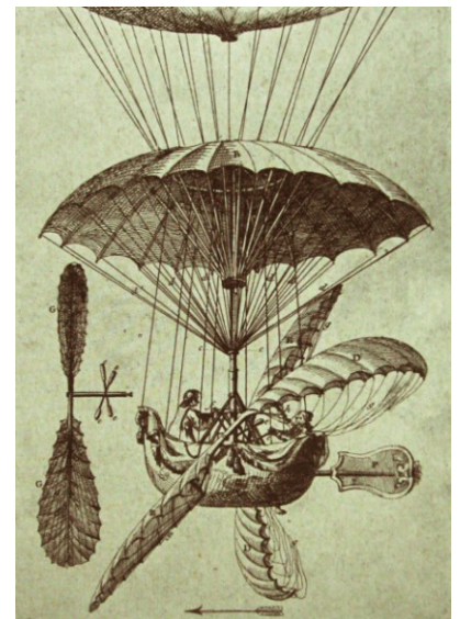
Barco volante de Jean Pierre Blanchard con paracaídas, a la derecha se aprecia el detalle de la barquilla. 1783 101
