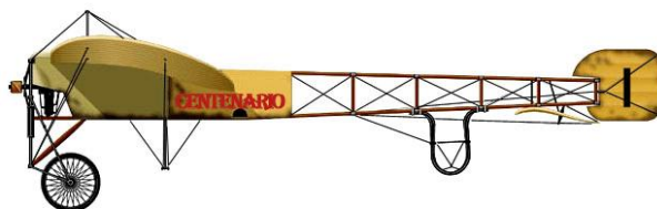
Bleriot XI N.º I Centenario (motor Gnôme Omega 50 hp)
