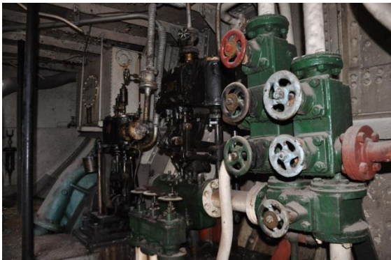
Bomba de agua de mar del condensador y bomba de lastre en TRIUNFADOR y CHALLENGE
