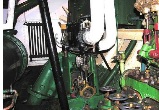
Bomba de agua de mar del condensador y bomba de lastre en TRIUNFADOR y CHALLENGE
