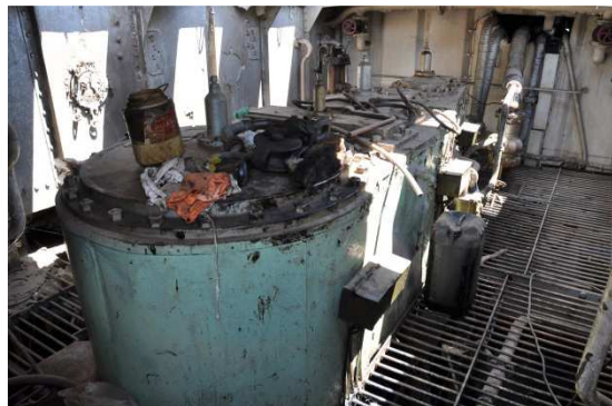
BIO-BIO telégrafo de órdenes y tapas de cilindros de máquina de triple expansión
