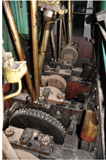
TRIUNFADOR cigüeñal y bielas de máquina de triple expansión
