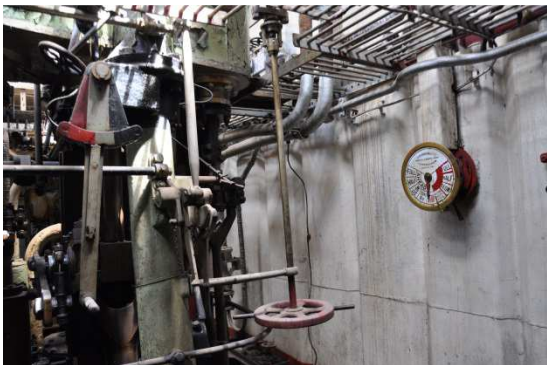
BIO-BIO telégrafo de órdenes y tapas de cilindros de máquina de triple expansión
